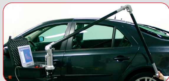
Mesure d'un véhicule avec la configuration grand volume du FLEX
