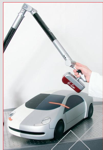
L'utilisation de G-Scan RX 2 apporte un gain de temps considérable sur la rétroconception de vos pièces au niveau mesure et triangulation par rapport à un moyen conventionnel par contact
