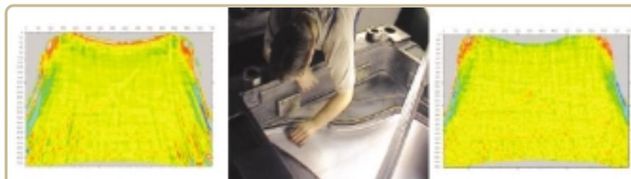
Figure 9 : aide à la finition de moule d'injection grâce à une mesure de courbures.
