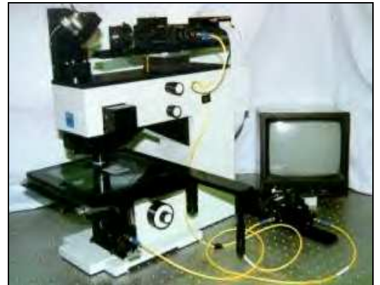
l Interféromètre de Mac-Zehnder pour le contrôle de microlentilles (Zeiss - Odem).
