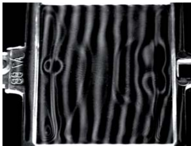
Déformations des franges liées à des problèmes d'injection
