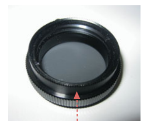
Filtre polarisant à monter sur l'objectif Filtre polarisant à monter sur l'éclairage
