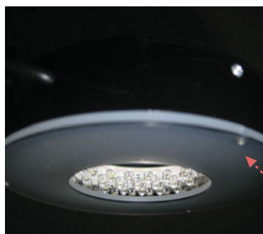
Filtre polarisant à monter sur l'objectif Filtre polarisant à monter sur l'éclairage
