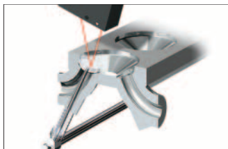
Mesure du mouvement d'un clapet de moteur
